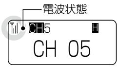
通話相手以外(同じ通話チャンネルで、異なる秘話キーを使用して通話している)の電波を受信しているときも、[送・受]ランプが緑色に点灯し、電波の受信状態を表示します。
