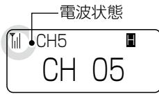
通話相手以外の電波(同じ通話チャンネルで誰かが通話中)を受信しているときも、[送・受]ランプが緑色に点灯し、電波の受信状態を表示します。
