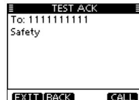
DSC設定の「TEST ACK」 (☞P65) を「Auto」に設定しておくと、ポジションリクエストを受信したときに自動で応答します。
