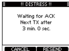
⑥ 受信証(ACK)を受信したら、[ALARM OFF]を押してから、マイクロホンで応答します。
