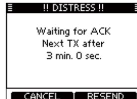
③ 受信証(ACK)を受信したら、[ALARM OFF]を押してから、マイクロホンで応答します。
