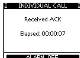
[ALARM OFF]を押してアラームを止めます。このとき、手順③で選択したIntership CH(船舶間通話チャンネル)を同時に選択します。
